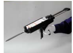
孔内に必要量の樹脂を注入してください。
