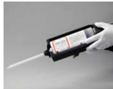
トリガーを前に押し出ししながらピストンロッドを完全に引き、カートリッジをセットします。
