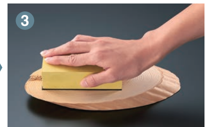
3 硬化を確認後、カンナなどで表面を平らにし、塗装する。
