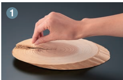
1 木材の割れ、節に同じ材質の木粉を充填する。
